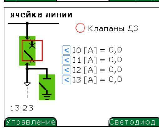
После выбора нужного соединителя и нажати перейдете к окну **Управление**, выбираем из списка доступных команд и подтверждаем .
