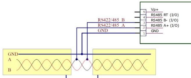
Рис. 5.1.1.1. Тип I - Промежуточное положение устройства в сети 2-кабельной связи.
