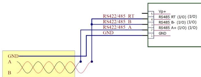
Рис. 5.1.1.2. Тип II - Крайнее положение устройства в сети 2-кабельной связи.
